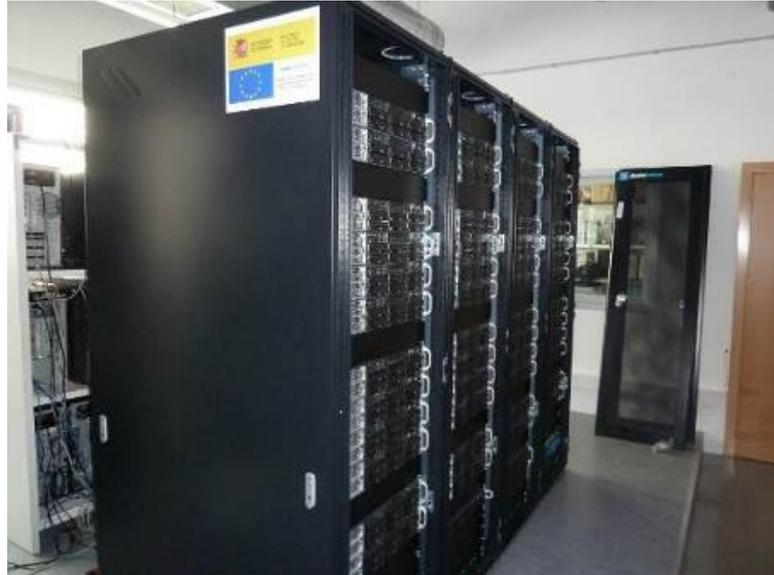
**Metodología y técnicas disponibles.** Memento ofrece un servicio clásico de cálculo en clúster HPC, estando por su configuración especialmente indicado para aplicaciones paralelas y/o con grandes necesidades de memoria RAM. El listado actual de software disponible en el sistema (ampliable bajo demanda de los usuarios) se puede consultar en: <http://bifi.es/en/infraestructures/scientific-equipment/memento-caesaraugusta/available-software>.
