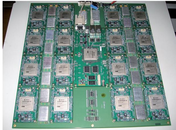
*Vista del interior de una placa de la máquina Janus compuesta por FPGAs*
