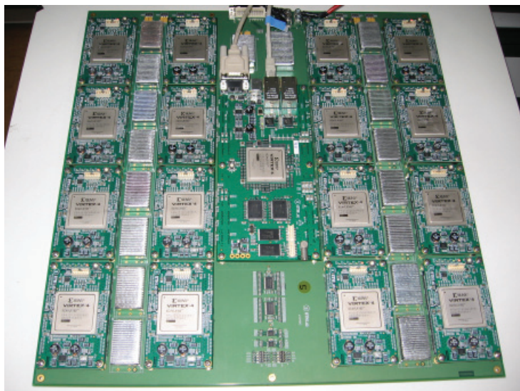
Vista del interior de la máquina JANUS compuesta por FPGAs
